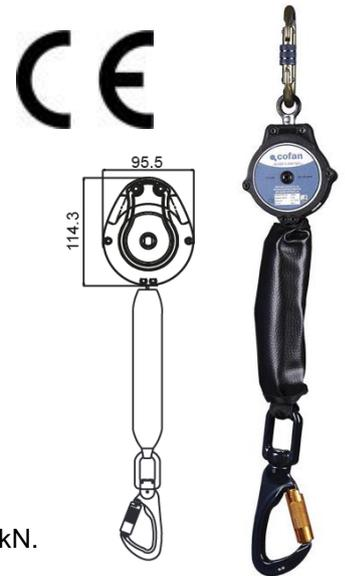
**Longitud máxima: 2 m. Anchura de la cinta: 20 mm. Peso: 1,00 kg. Resistencia > 15 kN.**
