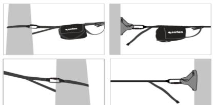
Línea de vida horizontal de correa de poliéster con extremos de tipo «horquilla» para enganche a una estructuras o a puntos de anclaje. Tensor de trinquete de acero para tensar el sistema una vez ajustada la longitud. Suministrado con una bolsa de almacenamiento no separable que permite guardar el excedente durante el uso, y guardar después del uso. Longitud ajustable de 2 a 20 m. Instalación rápida, temporal y sin perforar el punto de anclaje. No apto para trabajo en suspensión.
