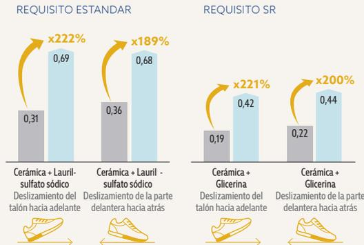
Prueba de resistencia al deslizamiento según EN ISO 20344:2021, realizado por Intertek Testing Services Shenzhen Ltd., en agosto de 2022; en una escala de 0,0 (sin resistencia al deslizamiento) a 1,0 (muy alto nivel de resistencia al deslizamiento, p.ej. en alfombras secas). Todos los zapatos SFC son equipados con la suela antideslizante patentada de Shoes For Crews.
