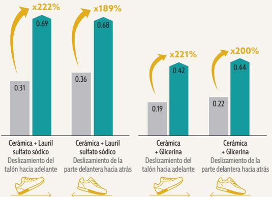
Prueba de resistencia al deslizamiento según EN ISO 20344:2021, realizado por Intertek Testing Services Shenzhen Ltd., en agosto de 2022, en una escala de 0,0 (sin resistencia al deslizamiento) a 1,0 (muy alto nivel de resistencia al deslizamiento, p. ej. en alfombras secas). Todos los zapatos SFC son equipados con la suela antideslizante patentada de Shoes For Crews. Producto probado: Carrig Low 62201.
