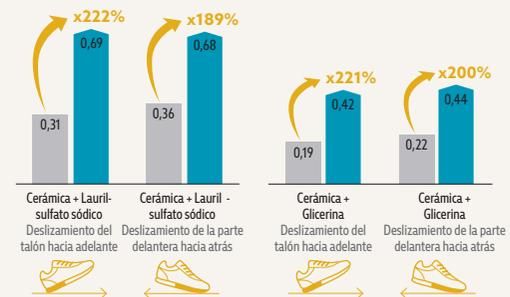
Prueba de resistencia al deslizamiento según EN ISO 20344:2021, realizado por Intertek Testing Services Shenzhen Ltd. en agosto de 2022; en una escala de 0,0 (sin resistencia al deslizamiento) a 1,0 (muy alto nivel de resistencia al deslizamiento, p. ej. en alfombras secas). Todos los zapatos SFC son equipados con la suela antideshlizante patentada de Shoes For Crews.
