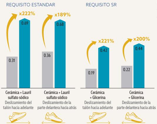
Prueba de resistencia al deslizamiento según EN ISO 20344:2021, realizado por Intertek Testing Services Shenzhen Ltd., en agosto de 2022; en una escala de 0,0 (sin resistencia al deslizamiento) a 1,0 (muy alto nivel de resistencia al deslizamiento, p. ej. en alfombras secas). Todos los zapatos SFC son equipados con la suela antideslizante patentada de Shoes For Crews. Producto probado: Carriig Low 62201.
