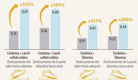
Prueba de resistencia al deslizamiento según EN ISO 20344:2021, realizado por Intertek Testing Services Shenzhen Ltd., en agosto de 2022; en una escala de 0,0 (sin resistencia al deslizamiento) a 1,0 (muy alto nivel de resistencia al deslizamiento, p. ej. en alfombras secas). Todos los zapatos SFC son equipados con la suela antideslizante patentada de Shoes For Crews.
