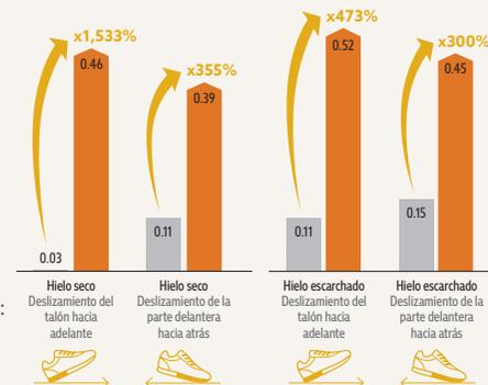
Prueba de resistencia al deslizamiento según EN ISO 20344:2021, realizado por Intertek Testing Services Shenzhen Ltd., en diciembre 2022, en una escala de 0.0 (sin resistencia al deslizamiento) a 1.0 (muy alto nivel de resistencia al deslizamiento), p.ej. en alfombras secas). Todos los zapatos SFC son equipados con la suela antideslizante patentada de Shoes For Crews. Producto probado: Darver/Callan Mid (62209/62204).
