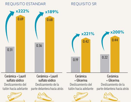
Prueba de resistencia al deslizamiento según EN ISO 20344:2021, realizado por Intertek Testing Services Shenzhen Ltd., en agosto de 2022, en una escala de 0,0 (sin resistencia al deslizamiento) a 1,0 (muy alto nivel de resistencia al deslizamiento, p. ej. en alfombras secas). Todos los zapatos SFC son equipados con la suela antideslizante patentada de Shoes For Crews. Producto probado: Carrig Low 62201.
