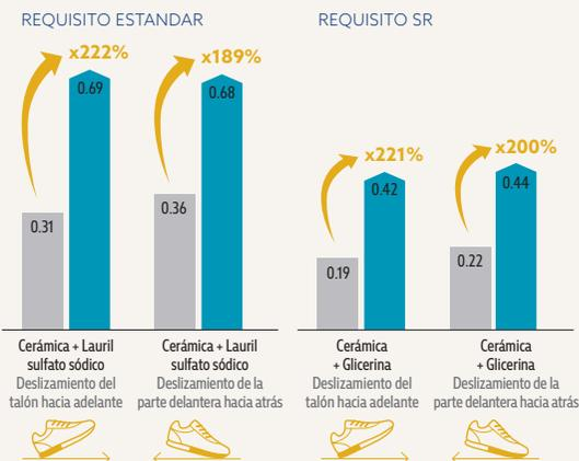
Prueba de resistencia al deslizamiento según EN ISO 20344:2021, realizado por Intertek Testing Services Shenzhen Ltd., en agosto de 2022; en una escala de 0,0 (sin resistencia al deslizamiento) a 1,0 (muy alto nivel de resistencia al deslizamiento, p. ej. en alfombras secas). Todos los zapatos SFC son equipados con la suela antisudorante patentada de Shoes For Crews. Producto probado: Carriy Low 62201.
