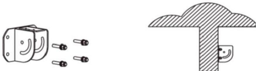
**Atención: preste atención a la seguridad durante el trabajo e instale tornillos de expansión de forma segura**
